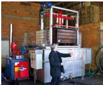
La machine Xeda expérimentée, avec un palox de pommes prêt à être immergé dans la cuve contenant de l'eau à 50 °C. Les fruits vont danser !
